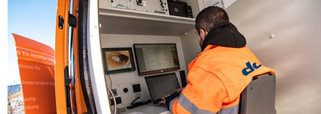
Eventuelle Mängel werden direkt vor Ort per mobiler Kamerabefahrung dokumentiert.
